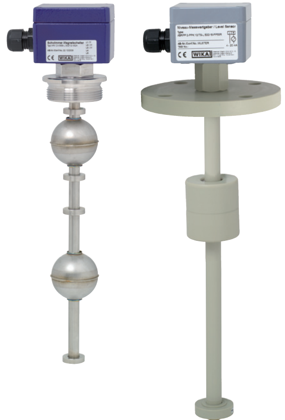
Schwimmerschalter mit Permanentmagnet, für vertikalen Einbau, Typ RSM Abb. links: CrNi-Stahl-Ausführung, Einschraubgewinde Abb. rechts: Kunststoffausführung, Flanschanschluss
