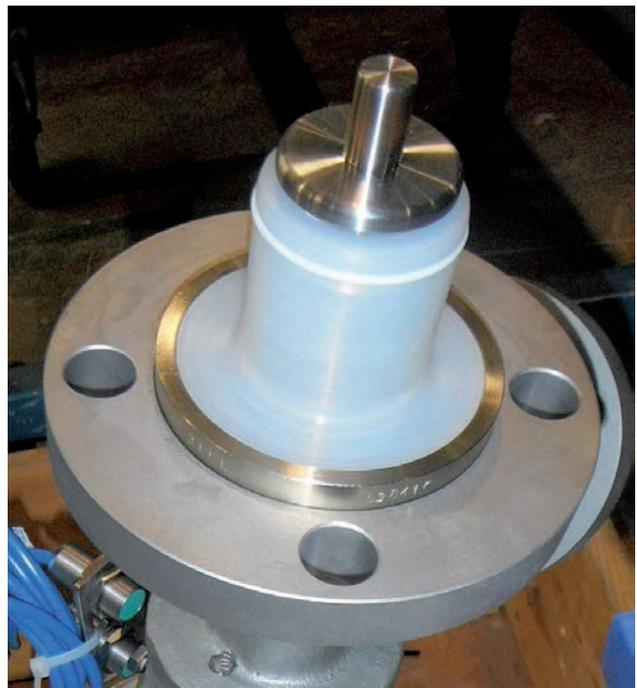
*Metallkegel mit erhöht eingebautem Temperaturfühler*
