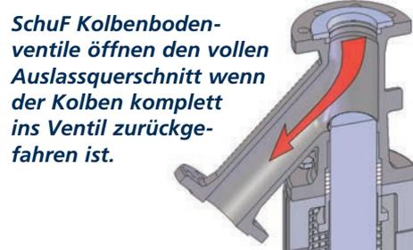
SchuF Kolbenventilsitze werden an die Abmessungen des Behälterflansches angepasst. Der Außendurchmesser des Sitzes ( $\varnothing d1$ ) ist 1 mm kleiner als der Innendurchmesser des Behälterstutzens. Die Höhe des Sitzes (X) ist an die Stutzenlänge angepasst und berücksichtigt eine Flachdichtung zwischen Sitz und Behälterstutzen.
