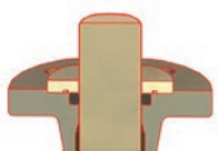
Modèle 28KV Joint (souple) radial dans le corps de vanne
