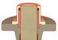
Modèle 28KR Joint (souple) radial dans la cuve
