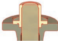
Modell 28KS Metallische Dichtung im Behälterflansch/-stutzen
