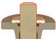
Modell 28KV Radiale Weichdichtung im Ventilkörper
