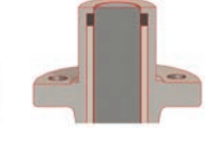
Modell 26FR Verlängertes Ventilgehäuse mit Radialdichtung
