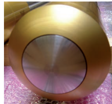
Regelkegel mit Wolframkarbidbeschichtung
