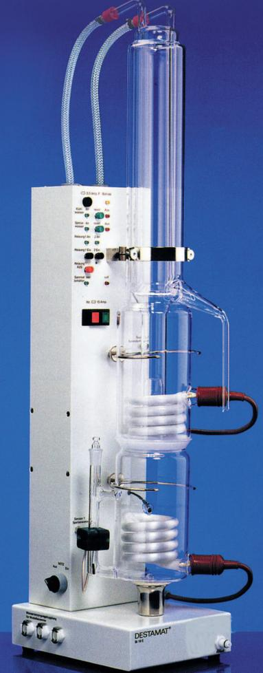
Alle mit Wasser in Berührung kommenden Teile bestehen bei der Bi 18 E aus Quarzglas. Es ist im Gegensatz zu gewöhnlichem Laborglas nicht hygroskopisch und deshalb beständig gegen H<sub>2</sub>O. Diese Eigenschaften sichern die hohe Reinheit des Destillates.
