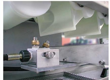
Für optimale Reinigungsergebnisse der Förderbecher lassen sich die automatisch verfahrenen Düsenstöcke in der Strahlrichtung, der Einwirkdauer sowie im Wasser- oder Luftdruck optimal einstellen.
