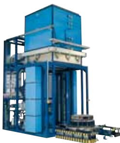
Gefügeänderungen / Härten / Anlassen Wärmebehandlung von Metallen unter Vakuum / Gas-Atmosphäre
