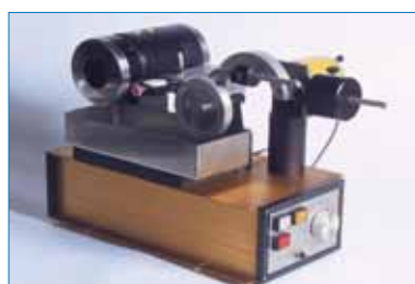
Diamantdrahtsäge für präzise Probenpräparation Diamond wire saw for precise sample preparation
