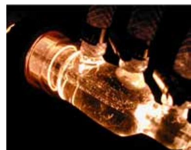
Beispiel für eine Quarzampulle, die einseitig aus dem Rohrfofen ragt. An example of a quartz tube projecting from a tube furnace.
