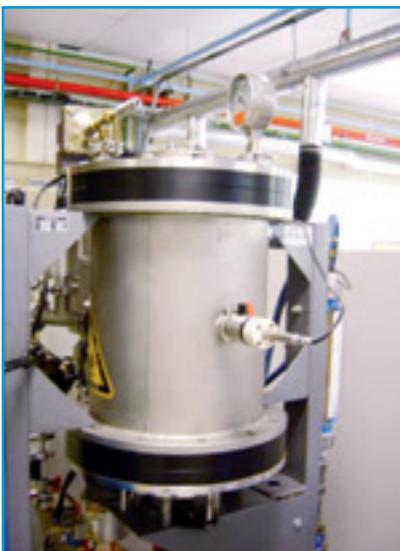
In der Praxis verwenden wir im Allgemeinen den Dampfdrucktest für die Prüfung des Thermokabels, die Dichtigkeitsprüfung mit flüssigem Stickstoff für die Schweißungen und den Heliumtest für die Durchführungshülsen und anderen Fixierkomponenten.
