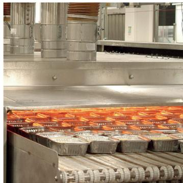
Carbon Infrarot-Strahler sorgen dafür, dass die Oberfläche der Nahrungsmittel schnell genug eine ausreichende Temperatur erreicht, um lokale Nässe wegzulassen und dann eine Bräunung ohne jegliche Möglichkeit des
