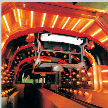
Härten von Lack auf Stoßdämpfern
