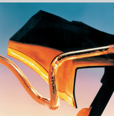
Kleber aktivieren auf einer Gummimanschette
