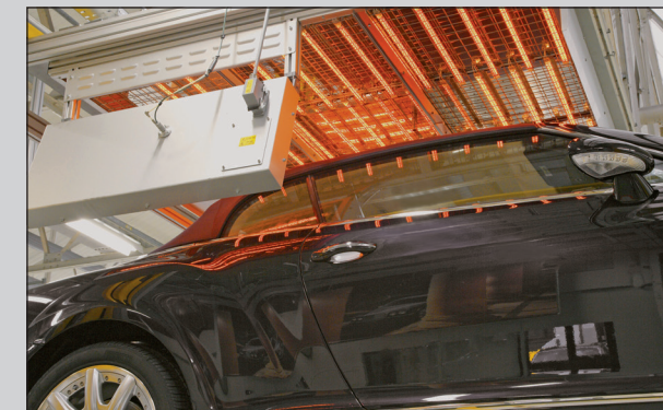
Kunststoffgewebe faltenfrei machen, hier Cabriodach
