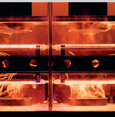
Verschweißen von Zylindern aus glasfaserverstärktem Polypropylen
