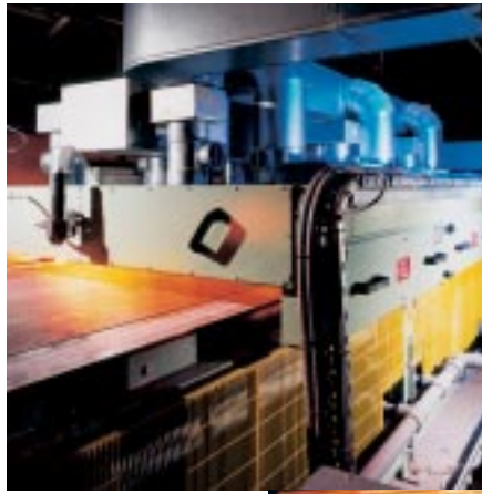
Séchage de la peinture des carrosseries
