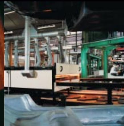
Thermoformage des moquettes intérieures
