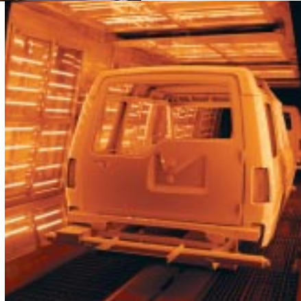
Séchage de la peinture des carrosseries
