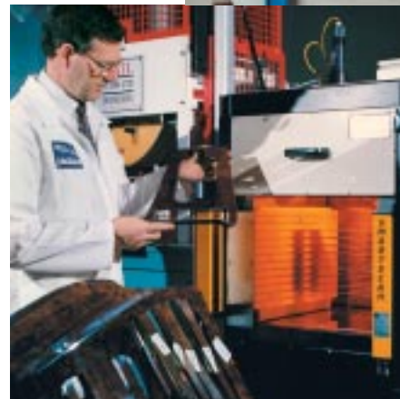
Thermoformage des habillages intérieurs
