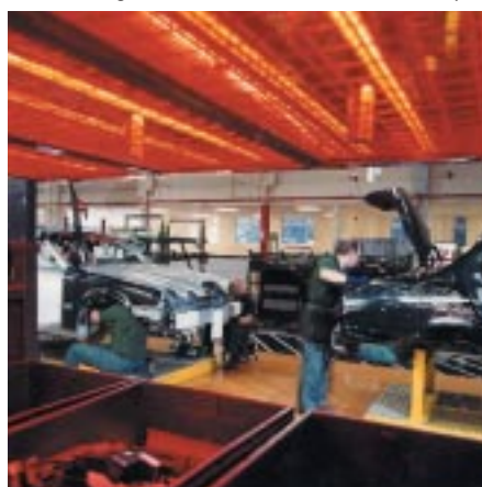
Préchauffage de faisceaux de câbles électriques
