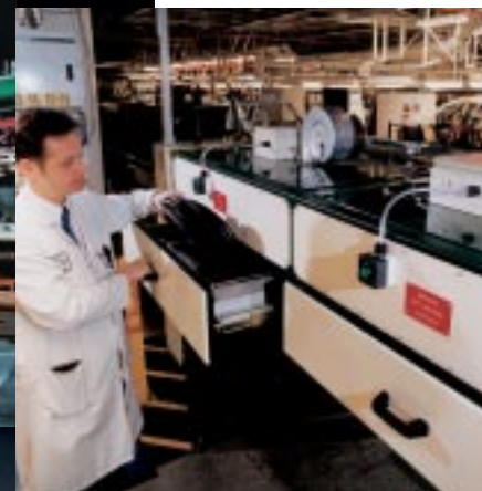
Préchauffage des baguettes de protection des portières
