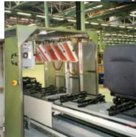
Traitement thermique des habillages de sièges
