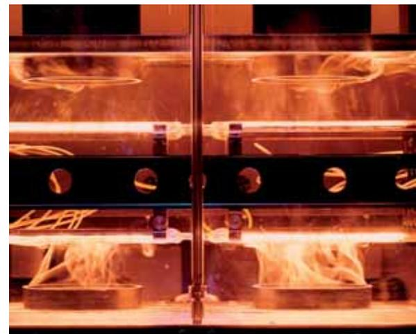
Les pièces en plastique sont chauffées simultanément dans des modules double face, puis assemblées.
