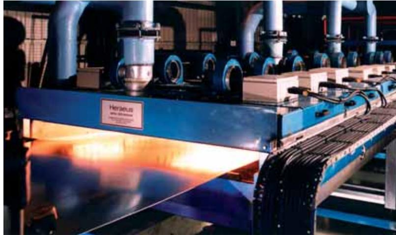
Séchage d'enduction sur bande métallique
