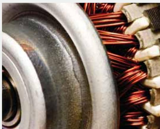
Les solutions ISOPAD de chauffage pour l'anticondensation de moteurs (ACM, anti-condensation motor) ont été spécialement conçues en collaboration avec de grands fabricants de moteurs afin d'empêcher la formation de condensation dans les enroulements moteur, qui sinon entraîneraient le dysfonctionnement soudain ou prématuré de l'équipement ; les rubans chauffants sont installés autour du stator et sont appréciés des fabricants comme des entreprises spécialisées dans le rebobinage de moteurs.
