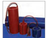
Das erwärmte Medium strömt leichter durch die Filterpatrone, was die Beanspruchung der Pumpen und Filter reduziert. Damit werden längere Wartungsintervalle ermöglicht. Durch die konstante Medientemperatur ohne „Hotspots“ werden Hitzeschäden und Kristallisation ausgeschlossen. Isopad Filterheizmanschetten sind mit Silikonschaum gedämmt und werden präzise an die Form des Filtergehäuses angepasst, sodass keine zeitaufwendige Befestigung mit Gurten oder Verschraubungen erforderlich ist.
