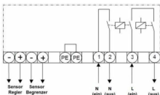
**Régulateur électronique de température et de sécurité ICon-T26000 (avec ou sans reset), équipé d'une fonction limiteur.**
