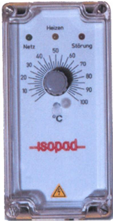
Régulateur à deux positions électroniques avec rétroaction PID, contact sans potentiel, pour éléments thermocouples ou Pt100.
