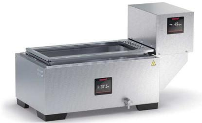
Wenn die Flüssigkeit in den Reaktionsgefäßen nicht ruhen darf, sorgt eine Schüttelvorrichtung SV, die auf das Wasserbad aufgesetzt wird, für die ständige Bewegung in horizontaler Richtung. Die zwischen 30 und 150 Hüben pro Minute frei wählbare Schüttelfrequenz kann am Display der Schüttelvorrichtung eingestellt werden – ebenso wie die Programmlaufzeit sowie ein Alarmschutz.
