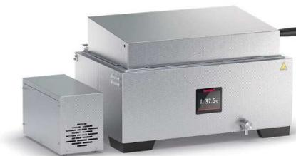
Die kontinuierliche Umwälzung des Temperiermediums mit einer Memmert Pumpvorrichtung CPM verbessert die thermische Homogenität. Diese selbstansaugende Pumpe ist für den Dauerbetrieb geeignet. Die Durchflussförderleistung beträgt 1,2 Liter pro Minute. Die Vorrichtung besitzt einen eigenen Netzstecker und kann jederzeit mit dem ON/OFF Schalter flexibel zu- oder abgeschaltet werden. Bitte beachten Sie, dass die Umwälzpumpe nicht in Kombination mit der Kühlvorrichtung verwendet werden kann.
